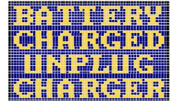
**NOTA:** Per preservare la durata del display, questo si spegne automaticamente dopo solo un minuto. Per visualizzare l'avanzamento della ricarica, è possibile premere un qualsiasi tasto (tranne ON / OFF) e il display si accende di nuovo.
