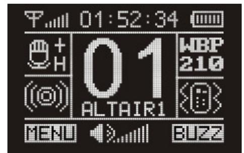
Dopo trenta secondi di inattività, il display e i LED del beltpack wireless riducono la luminosità per risparmiare energia, e dopo altri trenta secondi il display si spegne e i LED si abbassano ulteriormente.
