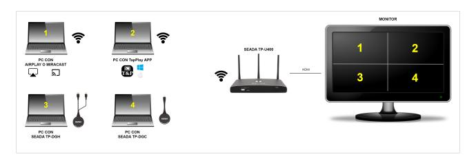
L'unità Tap&Play TP-U400 permette la condivisione senza fili di contenuti e consente la visualizzazione (con layout selezionabile) di un massimo di quattro dispositivi contemporaneamente .
