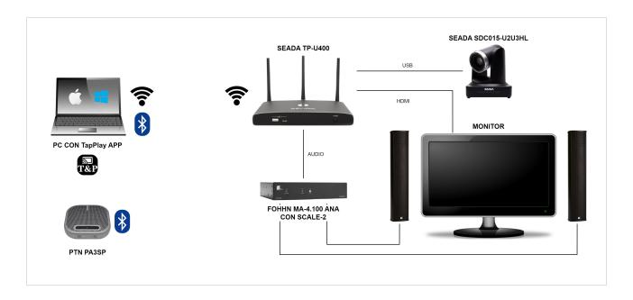
Il PC può condividere documenti sul monitor tramite la connessione Wi-Fi fornita dal sistema Tap&Play TP-U400 senza dover installare alcuna applicazione. Per la condivisione si possono utilizzare Miracast (Windows) o AirPlay (MAC).
